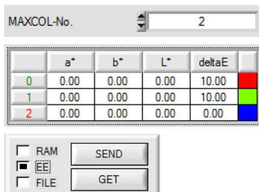
In diesem Beispiel wurde **MAXCOL-No.** = 2 ausgewählt, d.h., der Sensor soll die Farbinformationen wieder finden, welche in den ersten 2 Zeilen der **TEACH TABLE** durch externes Lernen über IN0 abgespeichert werden. Da sich der Sensor seine Toleranzen **deltaE** nicht selber berechnen kann, müssen diese Werte einmalig eingegeben werden (hier überall 10) und zusammen mit **MAXCOL-No.** sowie **EXTEACH = ON** im **EEPROM** abgespeichert werden.
