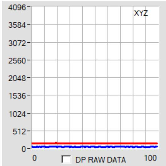
Die Farbraumkoordinaten werden, wie oben bereits erwähnt, mit den Rohdaten **X, Y** und **Z** welche man mit Parametersatz 2, erhält berechnet.
